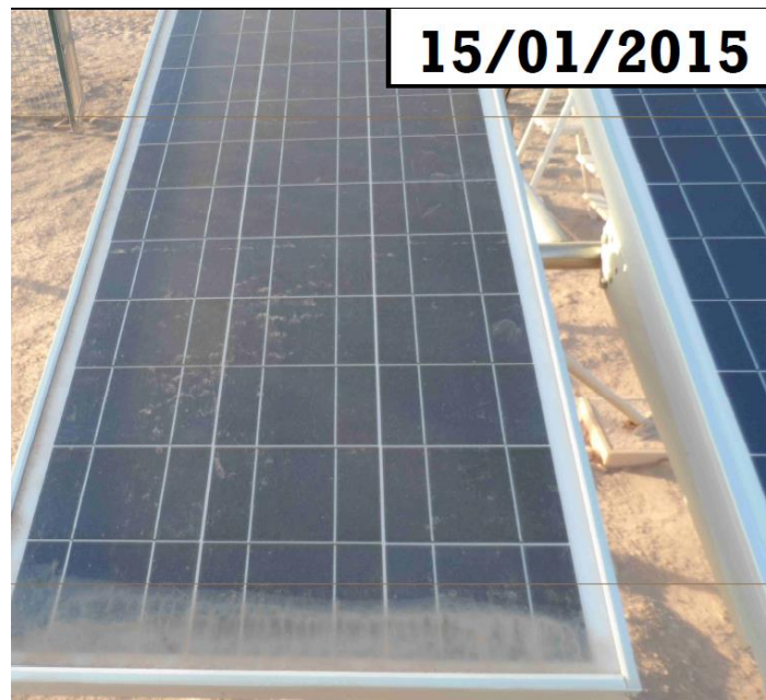
Figura 43: Modulo a prueba en Desierto de Atacama (15-01-15)
