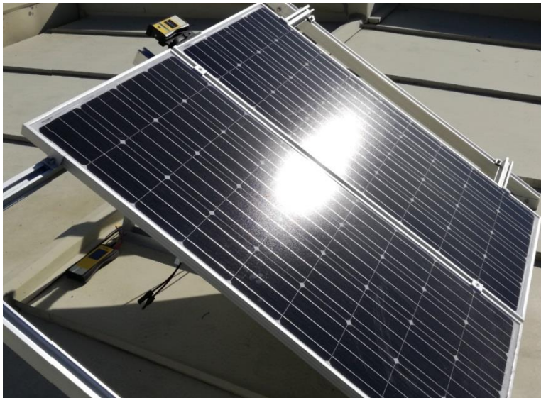
Figura 61: Laboratorio residencial con instrumento de curva I-V
