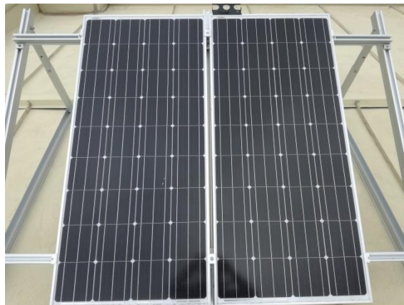
Figura 78: Fotografía 10° Medición - Paneles FV Sucio y Limpio
