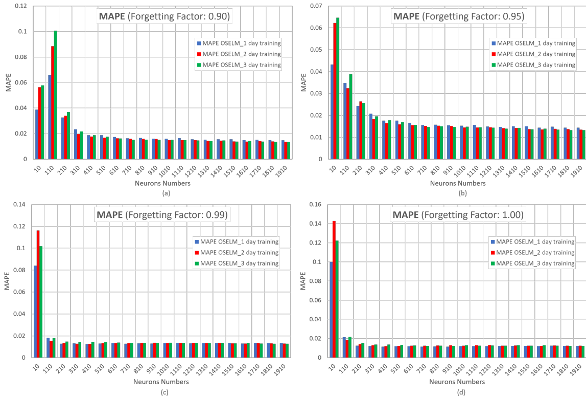
Figura 4.11. Métrica MAPE para red OS-ELM con valor de olvido en (a) 0.90, (b) 0.95, (c) 0.99 y (d) 1.00
